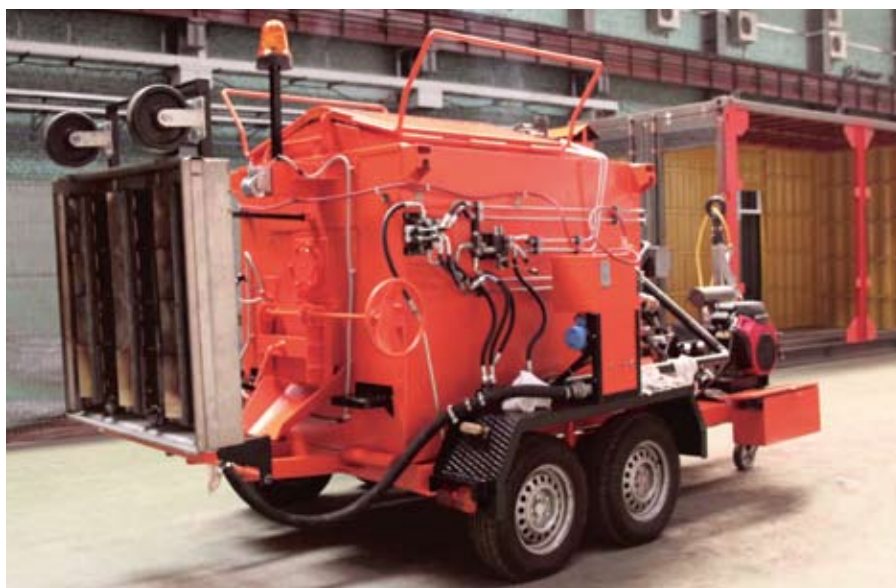
Установка для ямочного ремонта асфальтобетонных покрытий методом локальной терморегенерации
