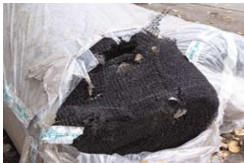
Рис. 1. Пример китайского контрафакта геосинтетики: а — состояние контрафакта в рулоне, б — сравнительный вид отбора проб отечественного материала (слева) и контрафакта (справа)
