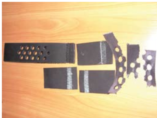
Рис. 2. Демонстрационные испытания китайского контрафакта на разрыв
