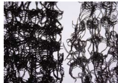
Рис. 1. Пример китайского контрафакта геосинтетики: а — состояние контрафакта в рулоне, б — сравнительный вид отбора проб отечественного материала (слева) и контрафакта (справа)
