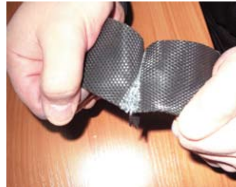
Рис. 2. Демонстрационные испытания китайского контрафакта на разрыв
