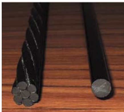
Слева — CFCC 1×7 Ø 10,5; справа — CFRP Ø 8,0
