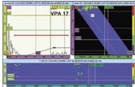
Рис. 7. А-, S- и C- сканы после ремонта дефекта в сварном шве
