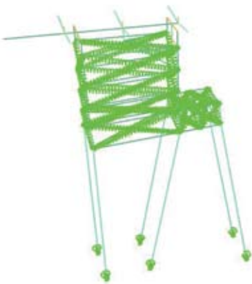
Рис. 13. Модель северного устоя для расчета методом конечных элементов с применением методики расчета железобетонных конструкций по аналогии с шарнирными фермами
