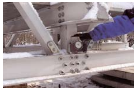
Измерение деформаций нижних поясов ферм
