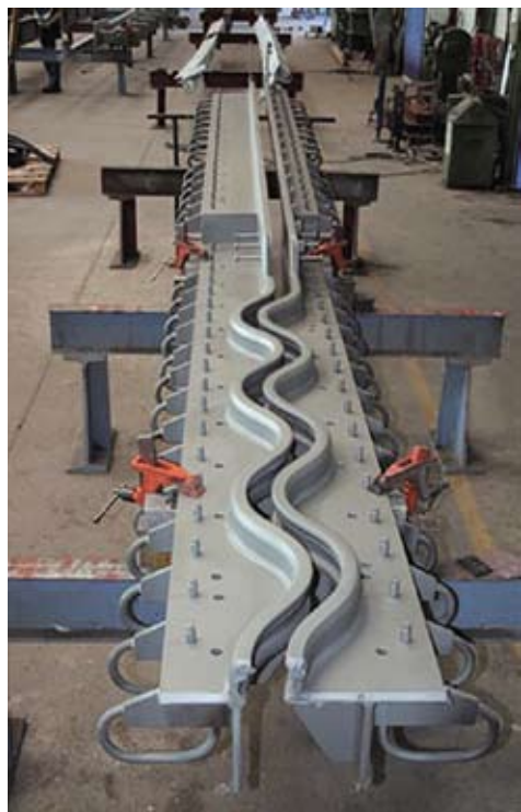
Сборка шва XW1 на заводе MAURER
