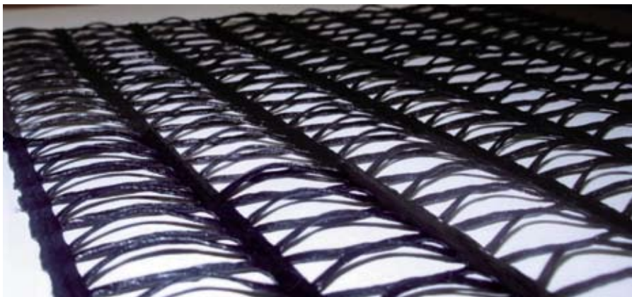
Рис. 6. Структура Геосклона 3D
