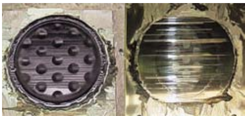
Шайба MSM® после испытаний на трение под давлением 60 Н/мм 2 со скоростью 15 мм/сек
