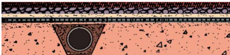
Рис.2. Использование резиновой крошки в качестве обсыпки инженерных сетей
