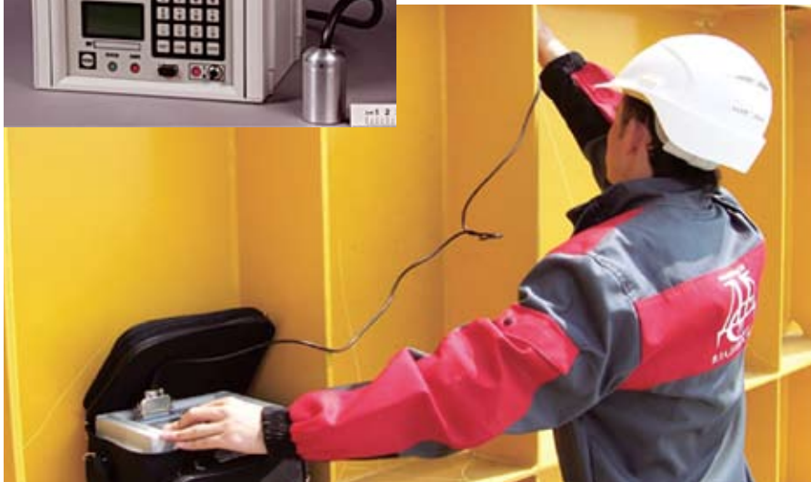
Рис. 8. Сканер дефектоскоп магнитно-анизотропный
