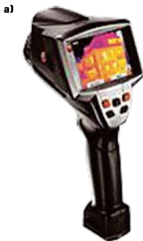
Рис. 2. Контроль подготовки основания перед бетонированием ростверка опоры М7: а — тепловизор; б — вид основания перед бетонированием; в — показания прибора
