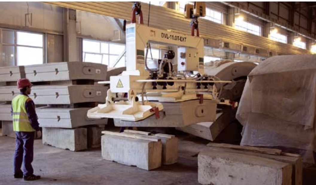
Завод по производству тьюбингов высокоточной тоннельной обделки в Сочи оснащен оборудованием компании Herrenknecht
