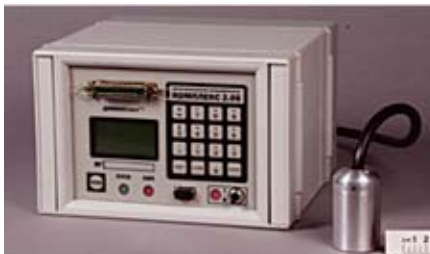
Рис. 7. Высокопроизводительный контроль сварного шва с помощью УЗФР
