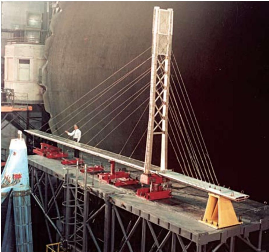
Рис. 5. Конструктивно подобная модель вантового моста через р. Обь в Ханты-Мансийском автономном округе — Югре (масштаб 1/25) в аэродинамической трубе Т-101 ЦАГИ
