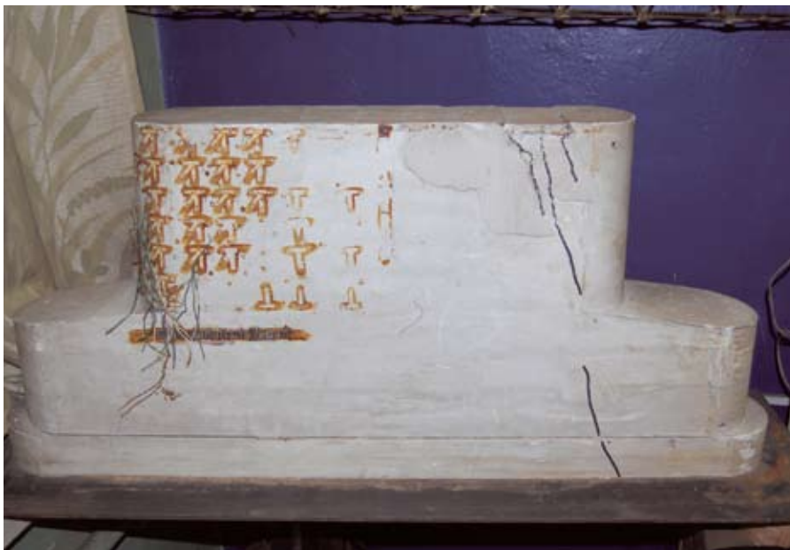
Рис. 3. Модель опоры моста через Волгу в Саратове, наклеены тензорезисторы и обозначены трещины
