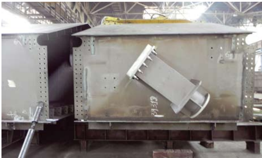
Узел анкерки вант на балке жесткости: а — схема; б — реализация
