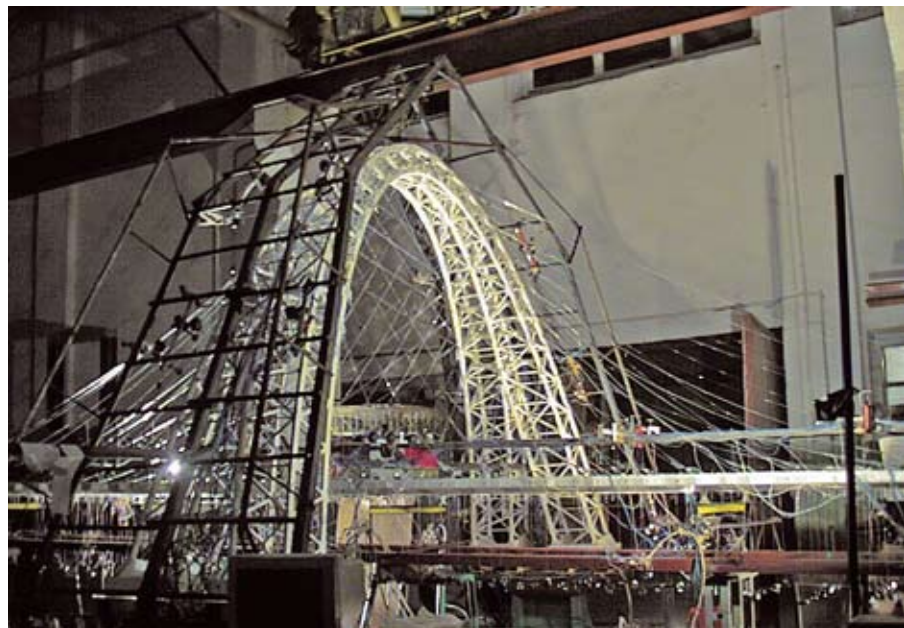
Рис. 2. Модель вантового пролетного строения Живописного моста в Серебряном бору в Москве.
