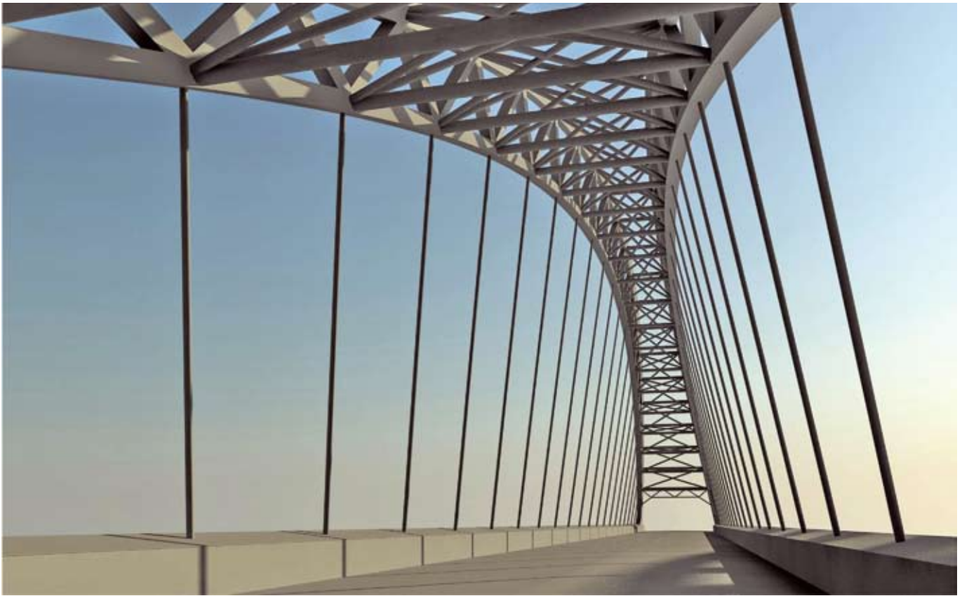
Визуализация арочного пролетного строения
