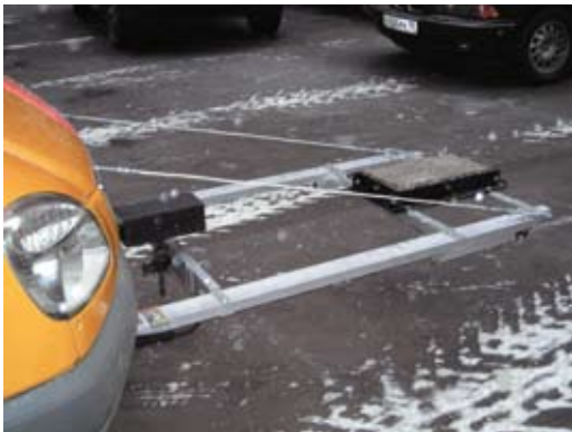
Рис. 3. Установка для измерения яркости дорожного покрытия по эталонному образцу
