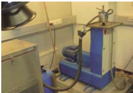
Рис. 2. Общий вид установки PRALL с подключенным к ней холодильником для охлаждения воды (используется вода с температурой +5 °С).
