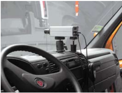
Рис. 1. Измеритель яркости дорожного покрытия в мобильной лаборатории
