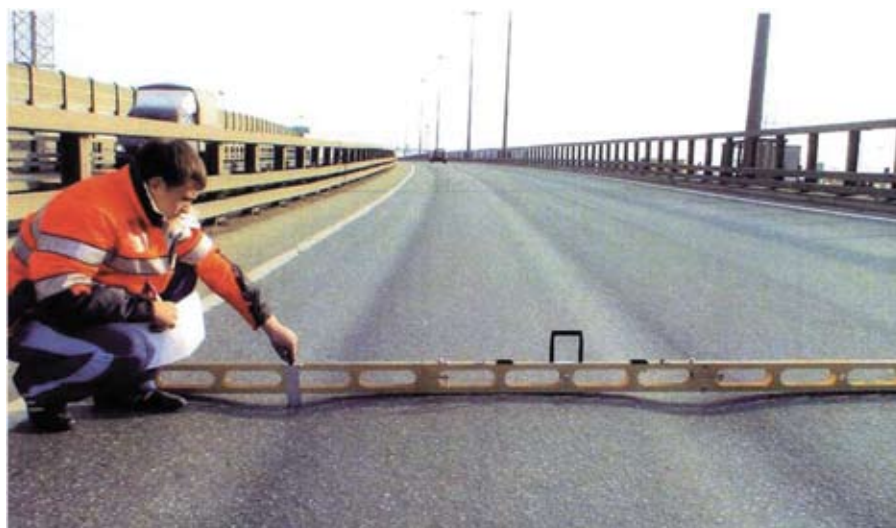
Рис. 1. Исследование колеяности асфальтобетонного покрытия на КАД СПб
