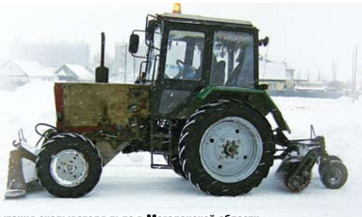
Испытания скалывателя льда в Магаданской области
