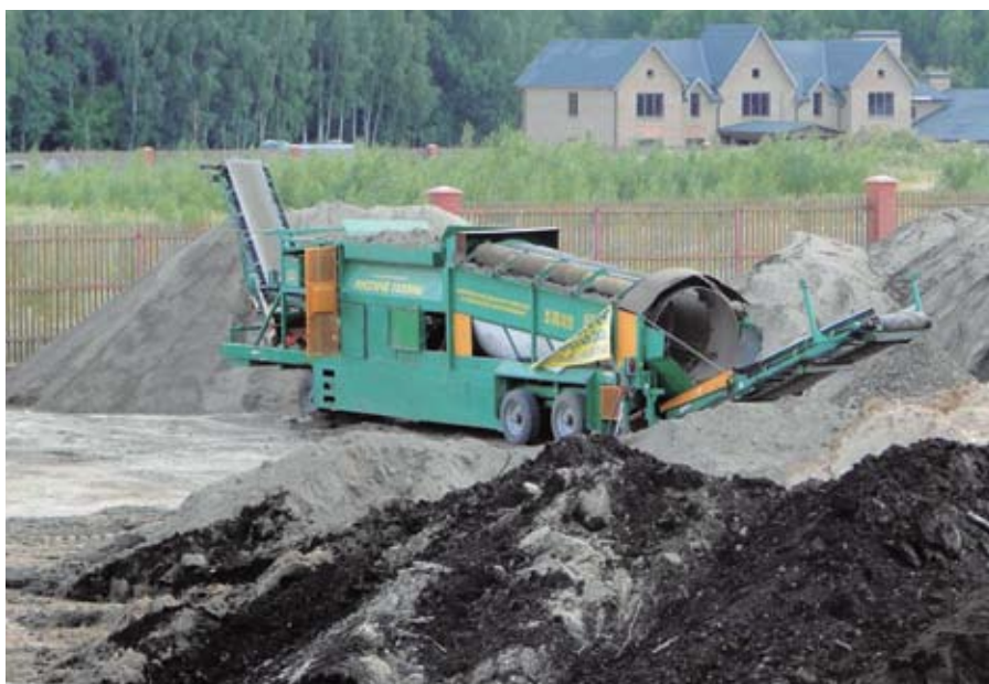
Рис. 7. Подготовка растительного грунта для укрепления откосов. Отсев остатков корней и обогащение лесного подзола торфом
