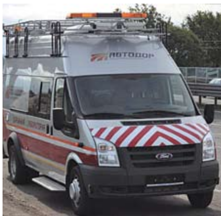
Передвижная лаборатория для георадарного сканирования
