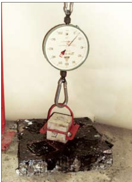
Испытания геосетки на адгезию к асфальтобетону: а — нормальное приложение нагрузки; б — горизонтальное приложение нагрузки
