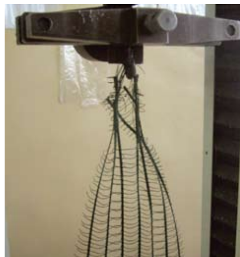
Испытания материала «Геосклон 3D»
