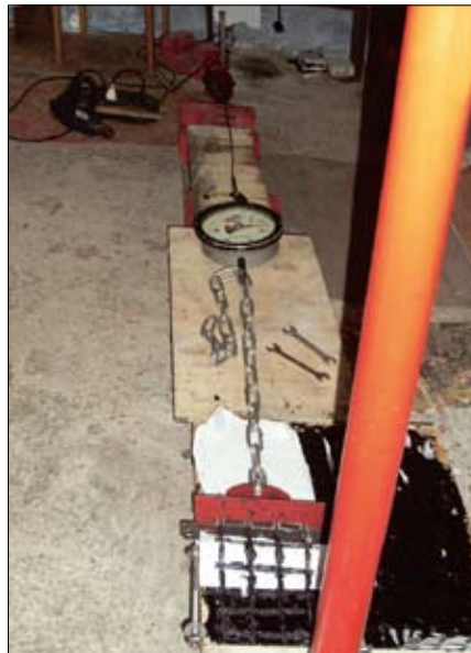
Испытания геосетки на адгезию к асфальтобетону: а — нормальное приложение нагрузки; б — горизонтальное приложение нагрузки
