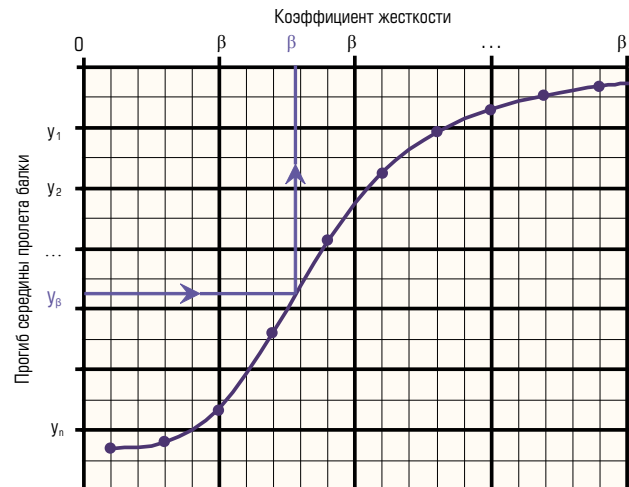
Рис. 6. Влияние коэффициента жесткости на прогиб среднего сечения балки
