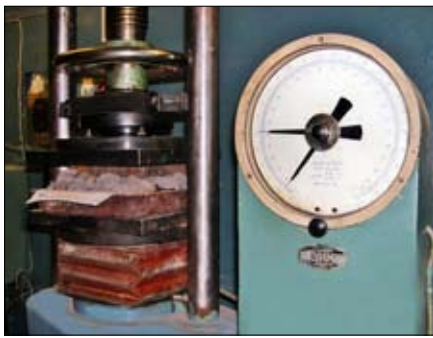
Общий вид установки для испытания геосинтетиков местными нагрузками
