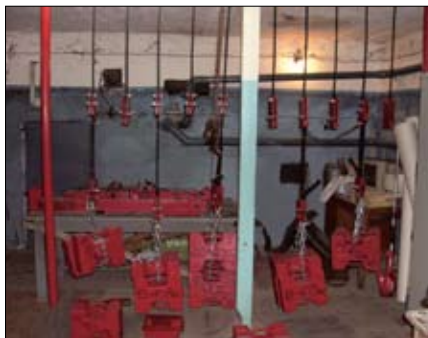
Испытание геосинтетиков статической нагрузкой
