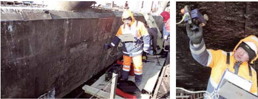
Рис.3. Поиск скрытых дефектов в бетоне конструкций. Результат сканирования
