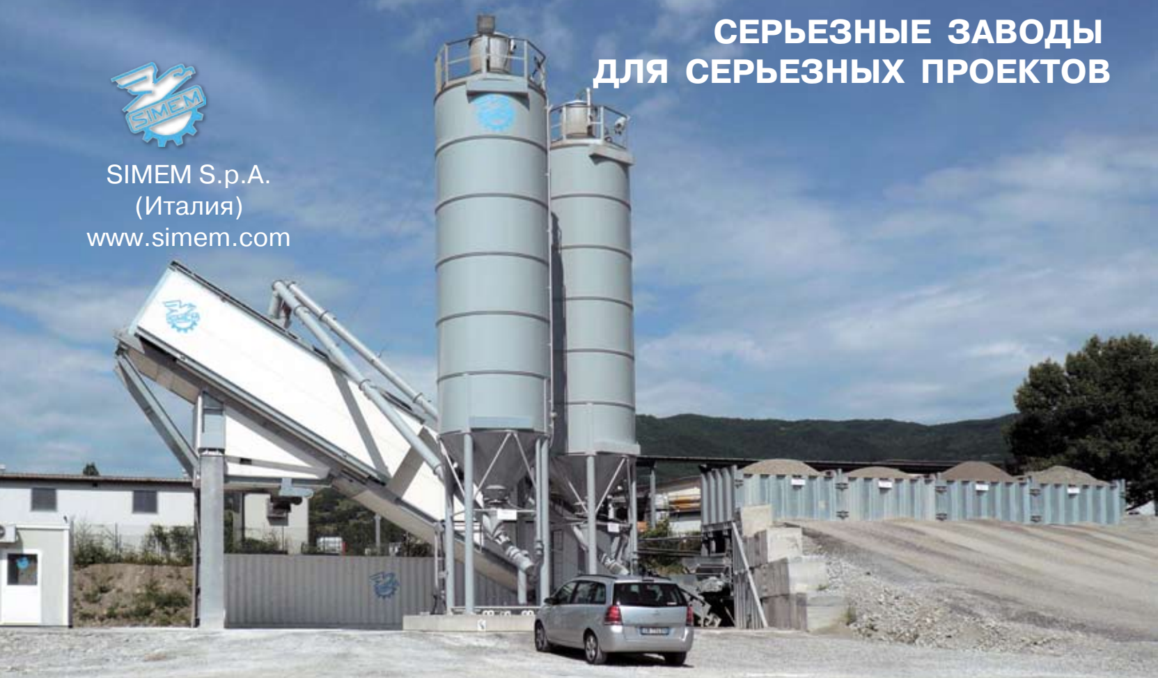
Супермобильная БСУ «ММХ-5000», 130 м 3 /час
