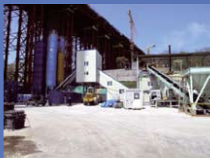
БСУ «Мобимикс-3000» на строительстве вантового моста через бухту Золотой Рог
