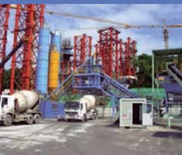
БСУ «Мобимикс-3000» на строительстве вантового моста через бухту Золотой Рог
