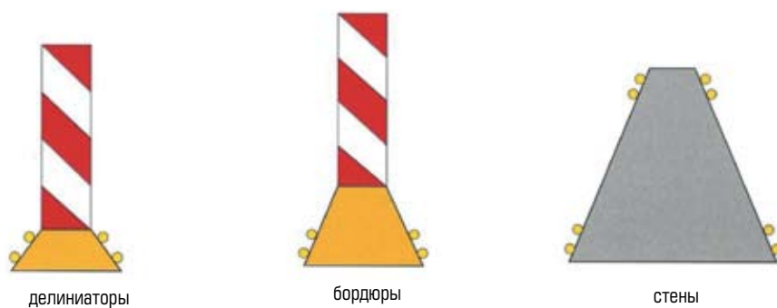
Рис. 5. Конструктивные направляющие элементы по нормам Германии
