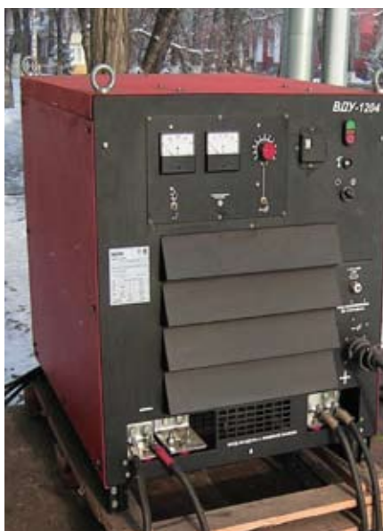
Испытания выпрямителя ВДУ-1204 в зимних условиях
