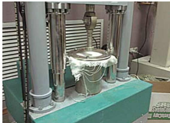
Проведение испытания на статическое прокалывание
