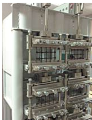
Испытание георешетки на ползучесть
