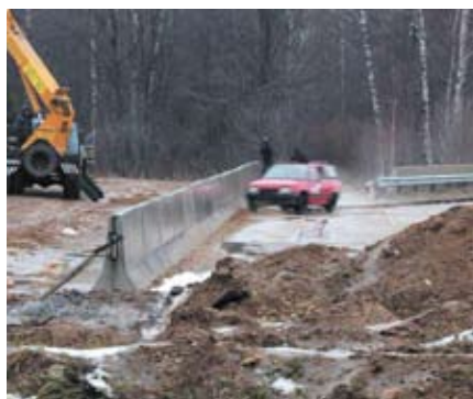
Рис. 1. Испытания железобетонных ограждений
