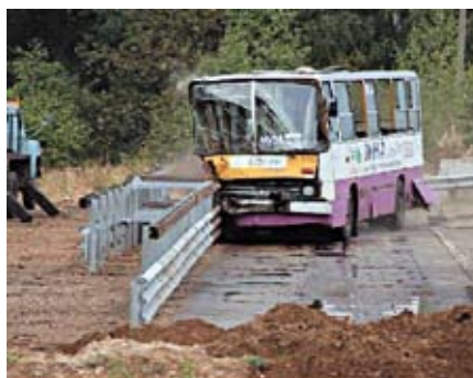
Рис. 1. Испытания барьерного ограждения ОАО «Завод Продмаш» на полигоне НИЦИАМТ ФГУП «НАМИ»
