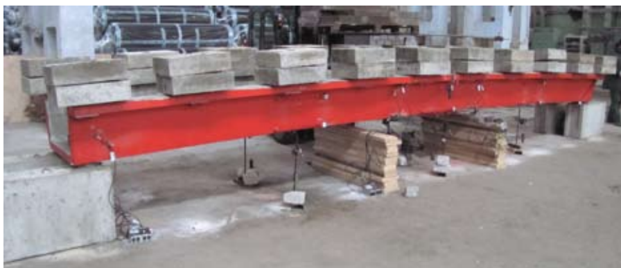
Заводские контрольные испытания цельнокомпозитной U-образной балки
