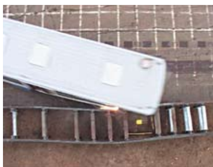
Рис. 2. Испытания (вид сверху). Желтой точкой отмечено условное искусственное сооружение
