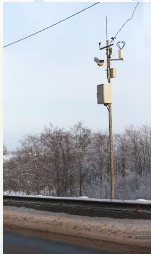
Рис. 1. Автоматическая дорожная метеорологическая станция ММ-МС4 типовой конфигурации
