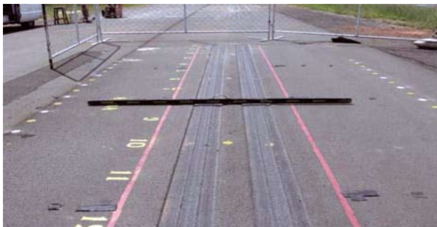
Испытания на имитацию реального воздействия транспортных средств на асфальтобетонное покрытие
