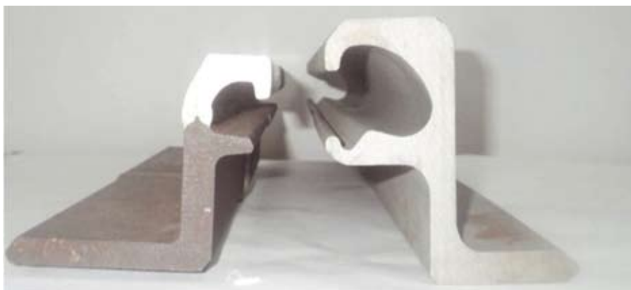
Профили окаймления деформационного шва: слева — зарубежная конструкция; справа — конструкция СК-80 ООО «НПП СК МОСТ»
