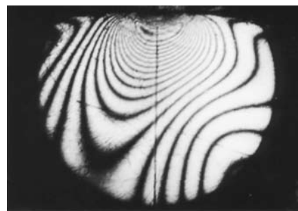
Рис. 1. Картина изохром при деформации роликом (цилиндром)
