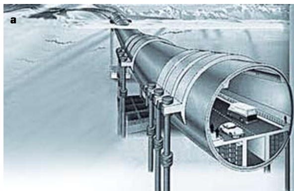
Рис. 4. Общий вид (а) и варианты поперечных сечений (б) «плавающего» тоннеля в Норвегии:
