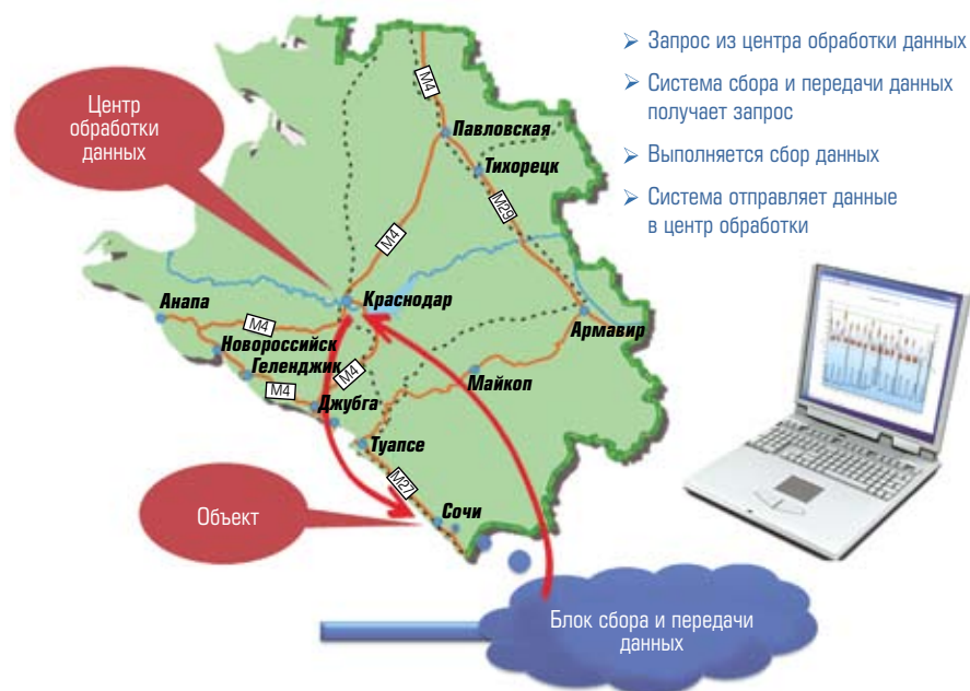
Рис. 2. Порядок функционирования автоматизированной системы мониторинга
