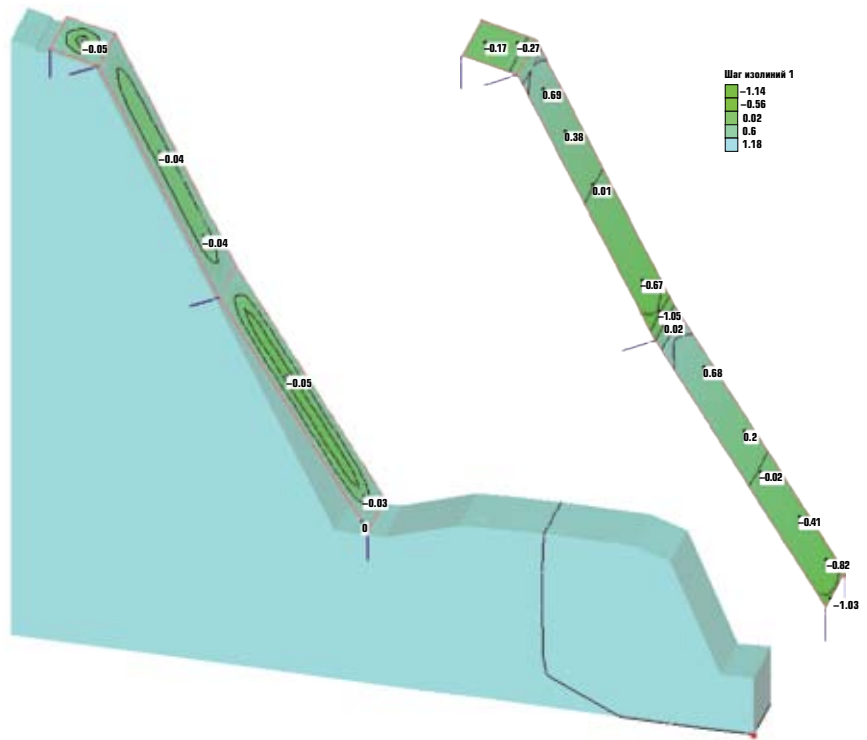
Рис. 4. Расчетная модель конструкции защиты для откоса полувыемки: а — изолинии вертикальных деформаций элементов конструкции, м; б — нормальные напряжения в георешетке, кПа
