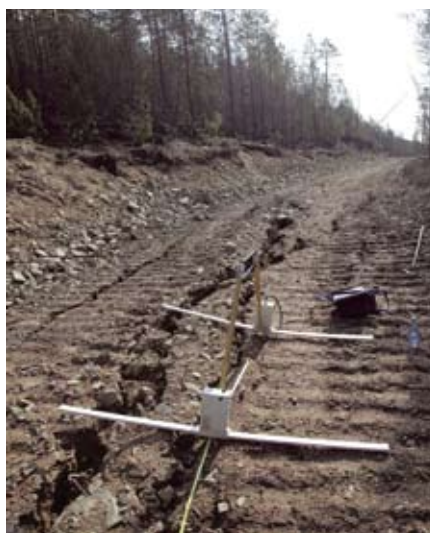
Рис. 2. Деформации оползневого участка на трассе автодороги
