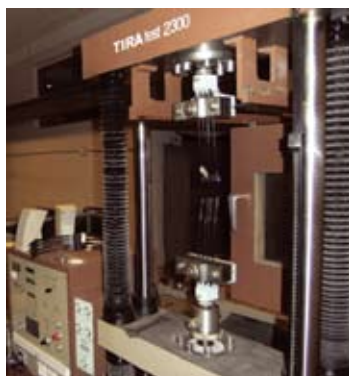
Рис. 10. Оборудование и данные оценки кратковременной прочности материала
