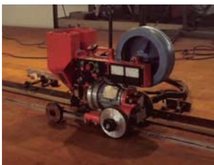
Рис. 2. Сварочный трактор ТС-16 и сварочный выпрямитель ВДУ-1204. Сварка без балластных реостатов
