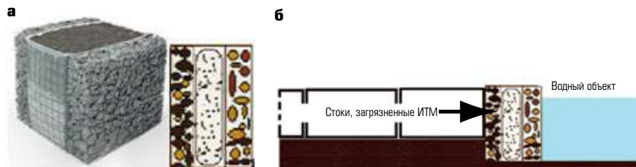
Рис. 2. Придание водоотводному сооружению экозащитных свойств: а — габионная конструкция с каменной и экозащитной загрузкой; б — устройство экозащитной габионной конструкции на выпуске из лотка для поверхностного водоотвода
