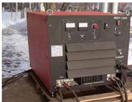
Рис. 2. Сварочный трактор ТС-16 и сварочный выпрямитель ВДУ-1204. Сварка без балластных реостатов
