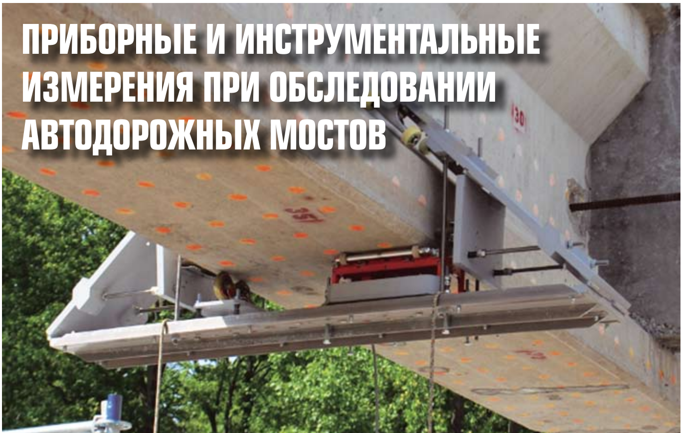
Рис. 1. Магнитный дефектоскоп «ИНТРОС» производства ООО «ИНТРОН ПЛЮС», установленный на контролируемой железобетонной балке
