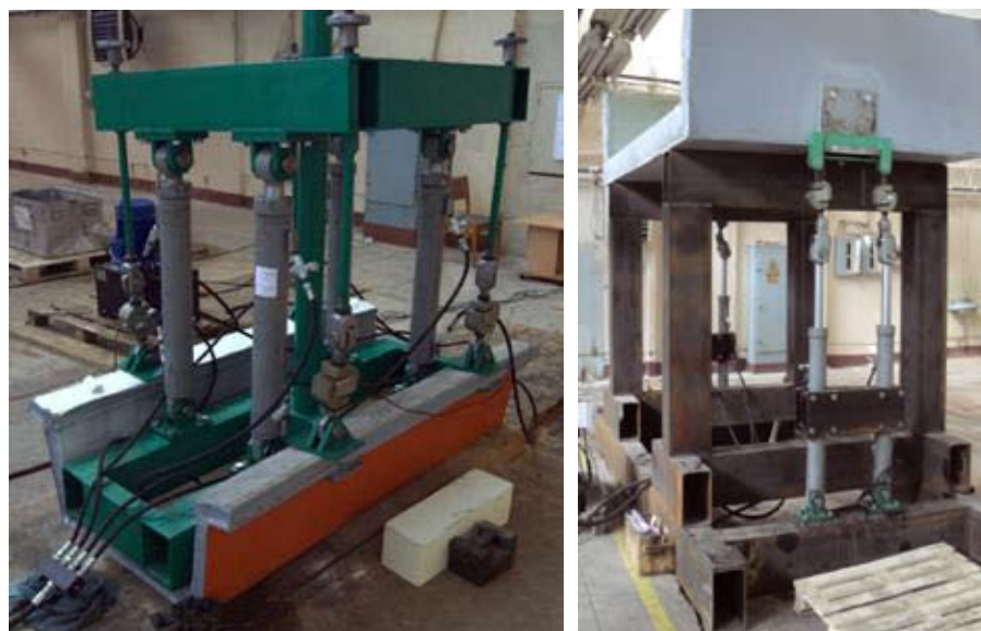
Рис. 10. Стенд для испытаний фрагментов мостовых конструкций
