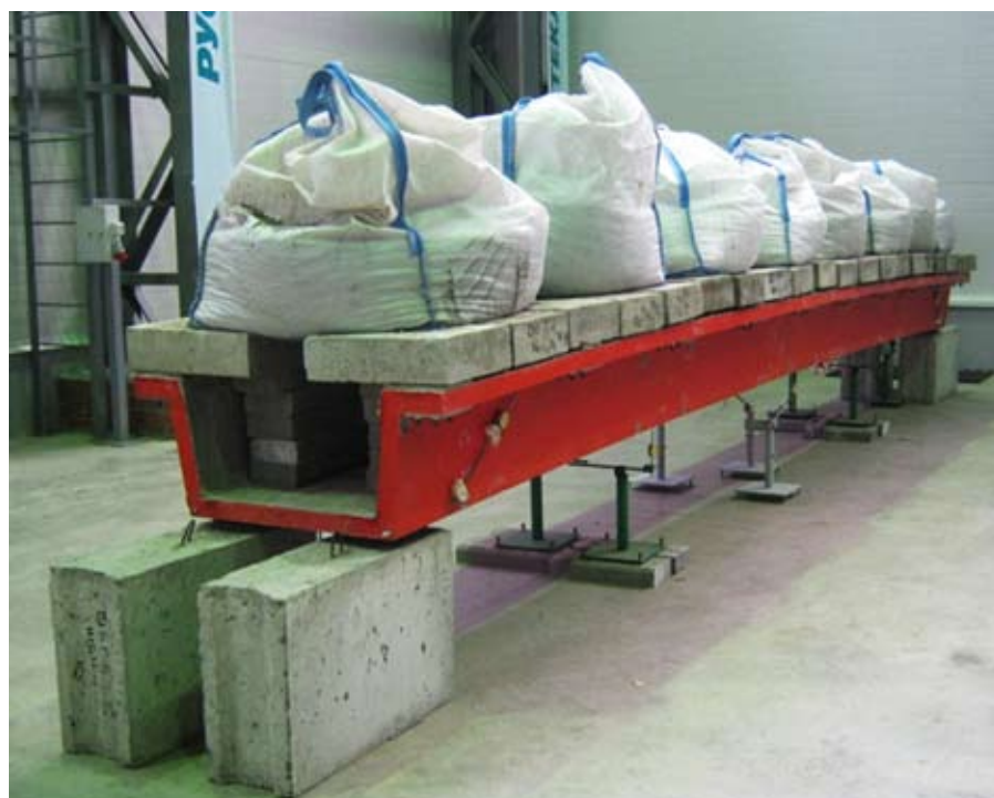
Рис. 11. Испытания масштабного пролетного строения на ползучесть
