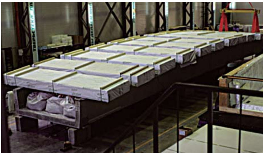
Рис. 12. Проведение испытаний пролетного строения
