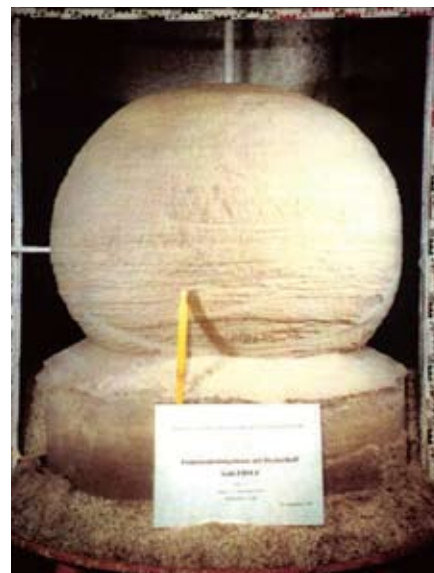
Рис. 1. Образец песчаного грунта (d = 1,0 м) после пропитки суспензией микроцемента
