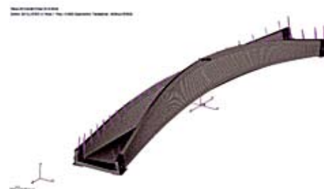
Рис. 6. Первая форма собственных колебаний пролетного строения частотой 5,6 Гц. Учитывается масса остекления.
