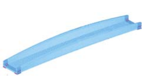
Рис. 4. Расчетная модель цельнокомпозитного пролетного строения пешеходного моста (длина 24 м, габарит проехной части 2,25 м). В модели более 1 млн степеней свободы.
