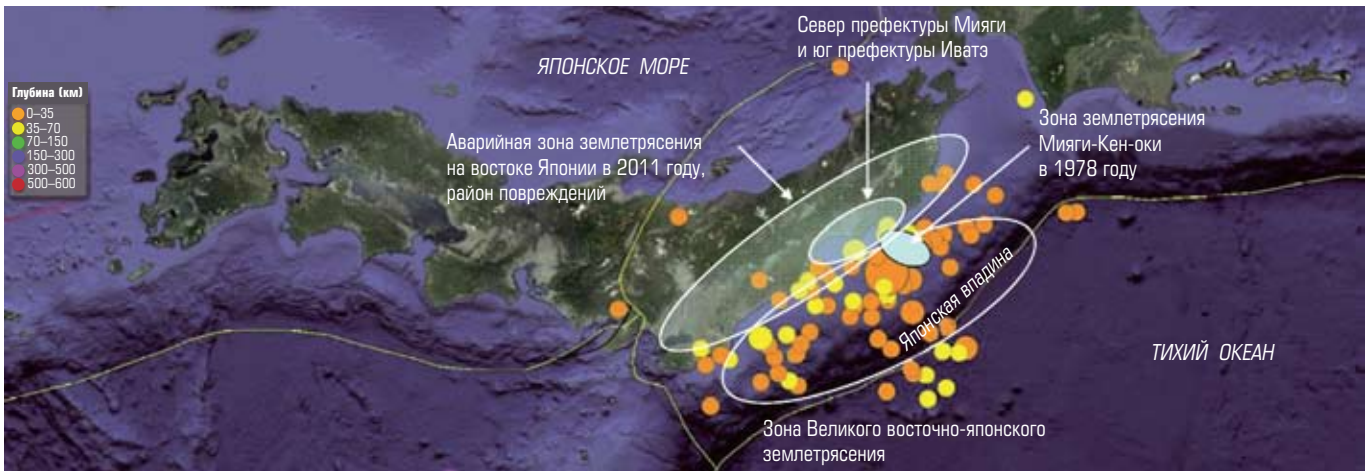
Рис. 1. Зоны разрушений, вызванные землетрясениями в 1978 и 2011 годах. Оранжевыми и желтыми кругами показаны эпицентры подземных толчков, большим оранжевым кругом — эпицентр землетрясения 2011 года на глубине 24 км
