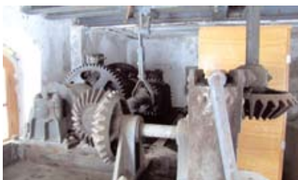
Открытые зубчатые передачи привода механизма разводки в опоре разводного пролета
