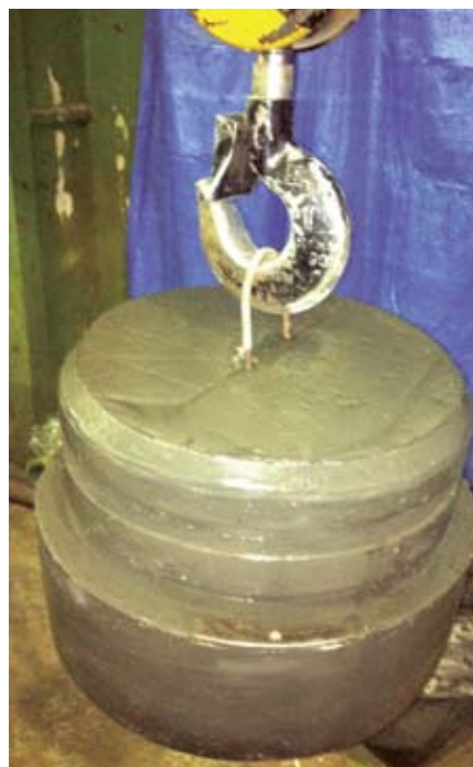
Башмак из сверхпрочного фибробетона под монолитные свайные железобетонные опоры в вытрамбованных грунтах
