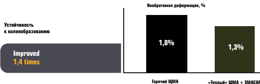
Устойчивость к колееобразованию при применении SMACAP
