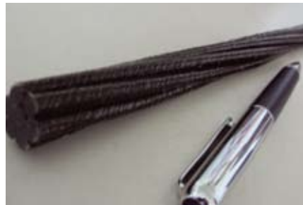
Рис. 8. Композитный вантовый трос БНВ для вантовых мостов
