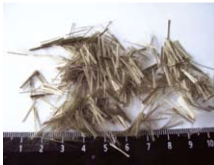
Рис. 2. Базальтовое рубленое волокно (базальтовая фибра). Диаметр элементарных волокон — 16 мк, длина — 12 мм
