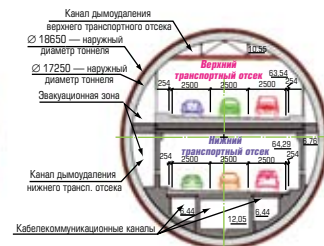
Тоннель диаметром 17,45 м — проектное решение (проходка МТПК диаметром 19,25 м)
