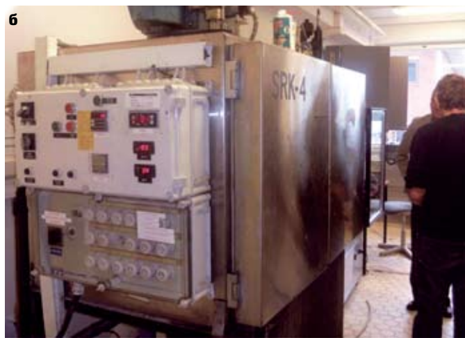
Рис. 1. Стандарт EN 12697-16, действующий в странах Северной Европы: А — шведский метод PRALL (а) ; В — финский метод SRK (б)
