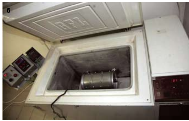
Рис. 3. Элементы установки АШМ. Испытания образцов асфальтобетона проводятся в растворе противогололедных материалов, которые будут использоваться при эксплуатации дороги (а) и при отрицательной температуре, характерной для региона эксплуатации дорожного покрытия (б)
