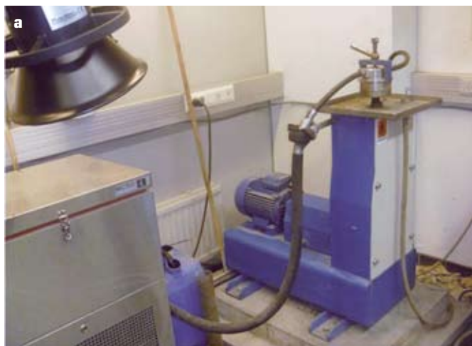
Рис. 1. Стандарт EN 12697-16, действующий в странах Северной Европы: А — шведский метод PRALL (а) ; В — финский метод SRK (б)
