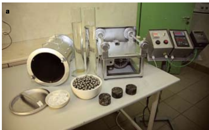
Рис. 3. Элементы установки АШМ. Испытания образцов асфальтобетона проводятся в растворе противогололедных материалов, которые будут использоваться при эксплуатации дороги (а) и при отрицательной температуре, характерной для региона эксплуатации дорожного покрытия (б)
