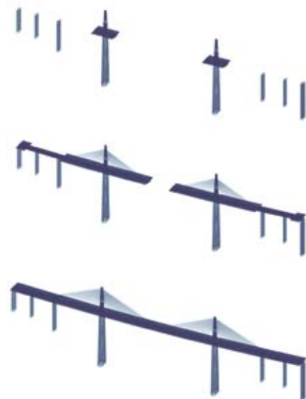
Расчетная модель виадука через долину реки Коргу
