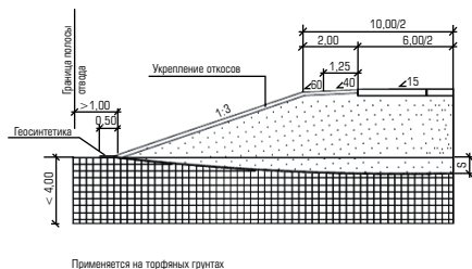
Рис. 1. Конструкция типа 1-С. Геосинтетика в основании
