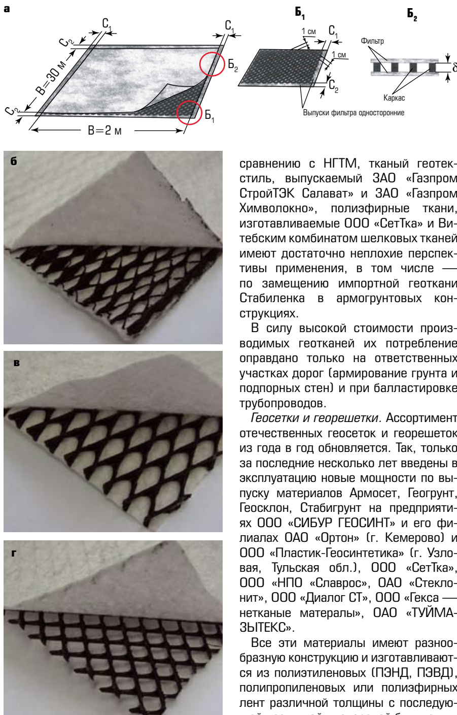
Рис. 2. Структура геокомпозитов, полученных путем дублирования полимерной сетки и иглопробивного полотна: а — схема получения геокомпозитов ООО «НПО «Славрос»; б, в, г — геокомпозиты других предприятий
