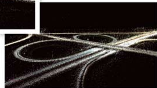
Результат трехмерного сканирования дороги с помощью МЛС Trimble MX2
