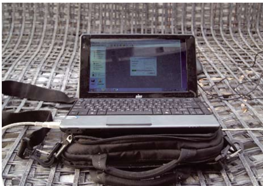
Получение данных наблюдения на персональный компьютер системы мониторинга армогрунтовых сооружений
