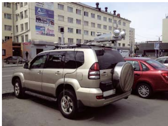
Установка МЛС Trimble MX2 в Челябинске
