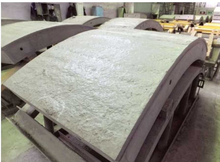
Применение системы покрытия на основе полимерцементной композиции Mapelastic для вторичной защиты железобетонных туннелей Московского метрополитена
