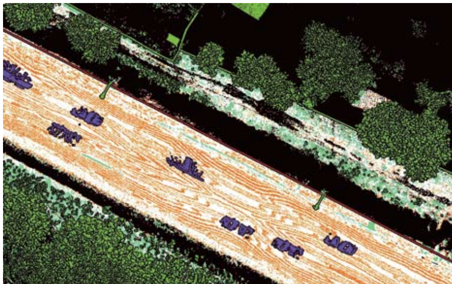
Классифицированные точки лазерных отражений
