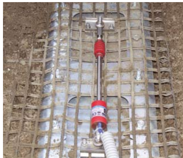
Струнный датчик перемещения системы мониторинга армогрунтовых сооружений
