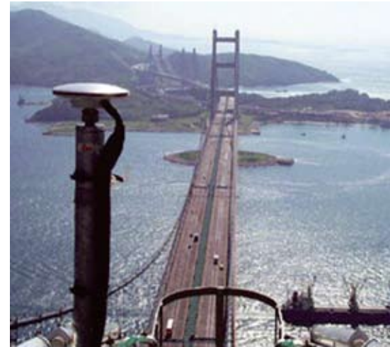
Рис. 1. GPS-приемник на вершине мостовой башни моста Тсинг Ма
