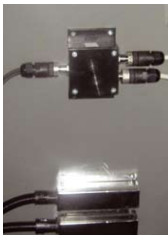
Рис. 2. Тензометрические датчики внутри пролетного строения
