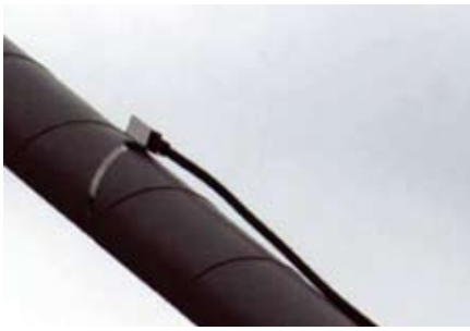
Рис. 4. Акселерометр, установленный на ванте.
