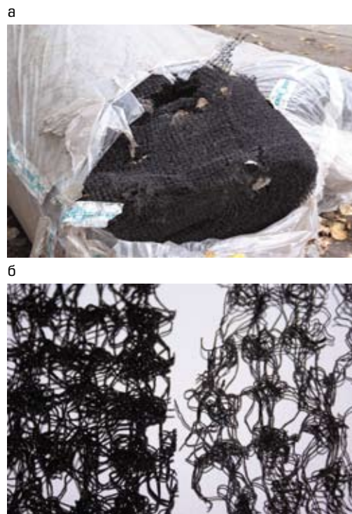
Рис. 1. Пример китайского контрафакта геосинтетики: а — состояние контрафакта в рулоне; б — сравнительный вид отбора проб отечественного материала (слева) и контрафакта (справа)
