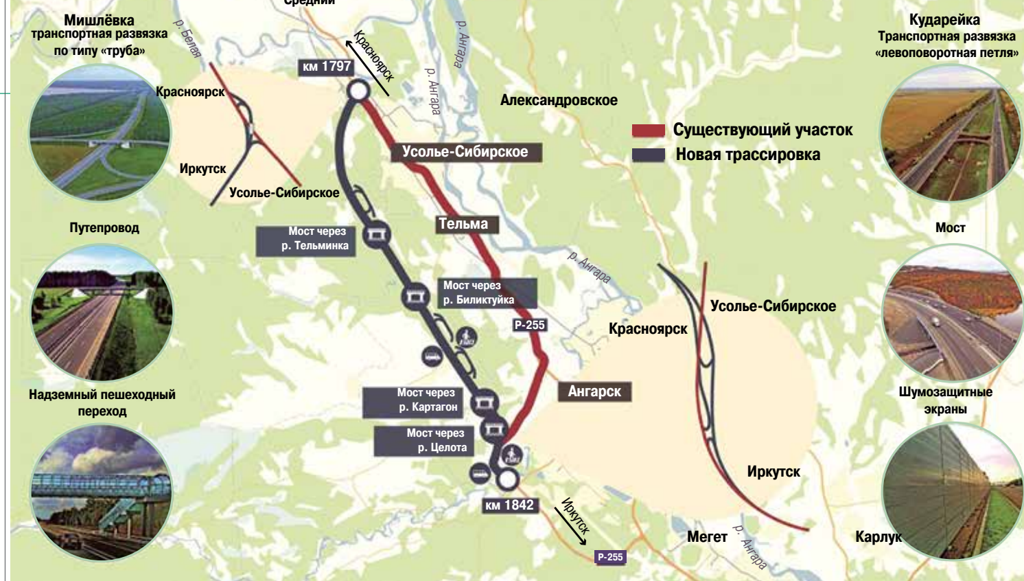
Строительство автомобильной дороги Р-255 «Сибирь» Новосибирск — Кемерово — Красноярск — Иркутск на участке км 1797+000 — 1842+000 (обход г. Усолье-Сибирское), Иркутская область
