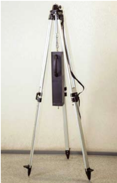
Рис. 2. Система SNS 100, оснащенная дополнительной опцией — устройством с постоянным магнитом
