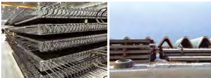
Плиты проезжей части пролетного строения
