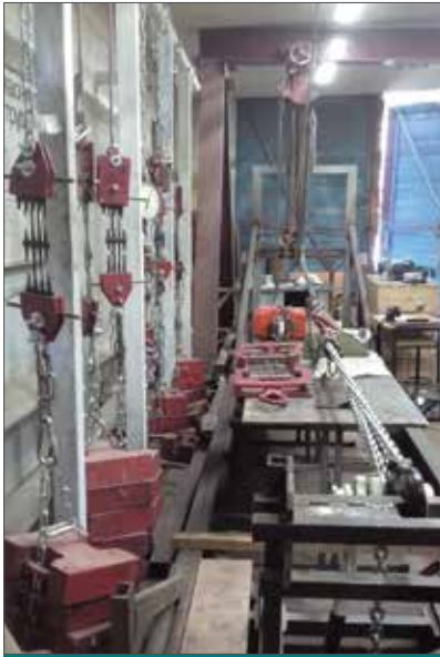
Рис. 1. Стенд для испытания на ползучесть геосинтетических материалов РСЦ-25
