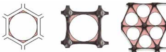
Рис. 2. Заполняемость ячеек георешетки с различными формами
