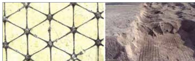
Рис. 7. Повреждение треугольной формы ячейки после уплотнения каменного материала
