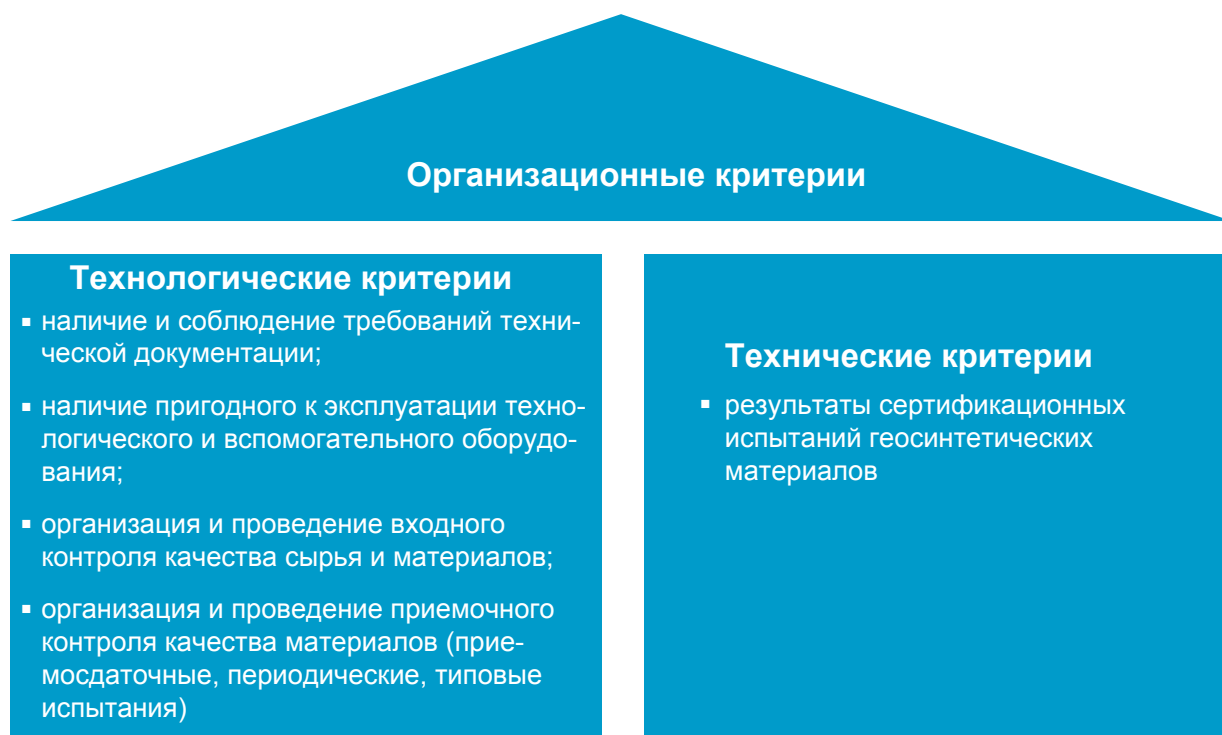
Рис. 2. Группы критериев сертификации производства геосинтетических материалов в системе «Автодорсерт»
