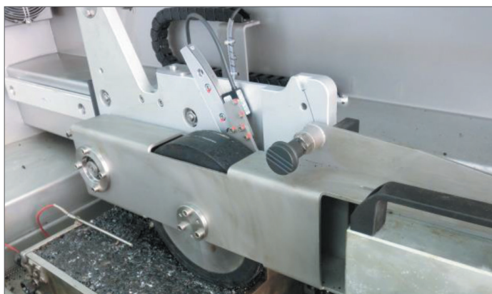
Установка InfraTest для определения устойчивости асфальтобетона к колееобразованию
