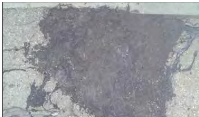
Рис. 3. Пример тестового эксперимента по определению времени превращения диспергированного состояния битумной суспензии в пленочное (распределение шпателем)
