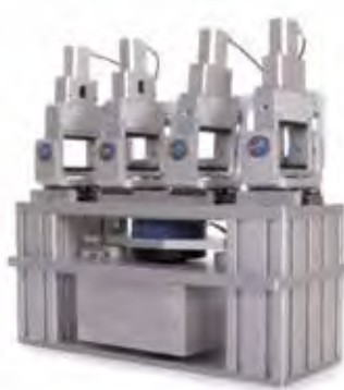
Рис. 1. Сервопневматическая установка Соорег для испытания на четырехточечный изгиб
