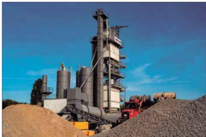
■ ABP 240–400 HRT производительностью от 240 до 400 т/ч с применением рециклинга.
