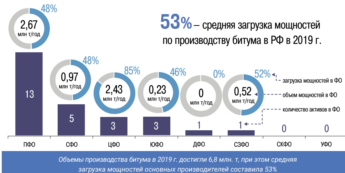
Локализация и загрузка активов основных производителей битума в РФ в 2019 г., ед., %
