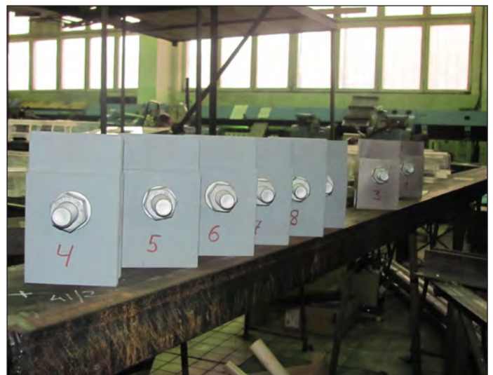
Рис. 3. Образцы с контактными поверхностями, обработанными дробеструйным способом и покрытые протекторной грунтовкой ЦВЭС перед испытанием на прессе
