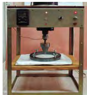
Рис. 2. Макет устройства для испытания на динамическое продавливание геосинтетических полотен
