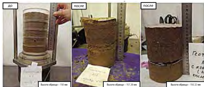
Рис. 3. Образцы мерзлого грунта, демонстрирующие мерзлотное пучение, без геокompозита и с ним
