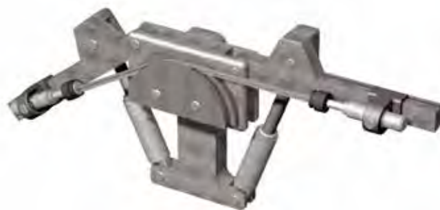
Рис. 6. Твердотельное моделирование технологического робота для гибки с растяжением (ПГР-6АД)
