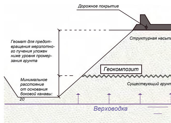
Рис. 4. Укладка геокомпозита
