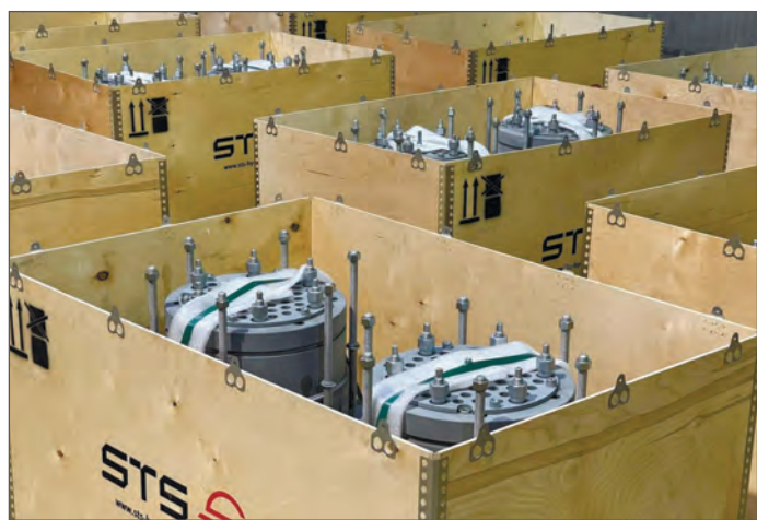
Рис. 2. Вантовые анкера отгружаются с производства СТС
