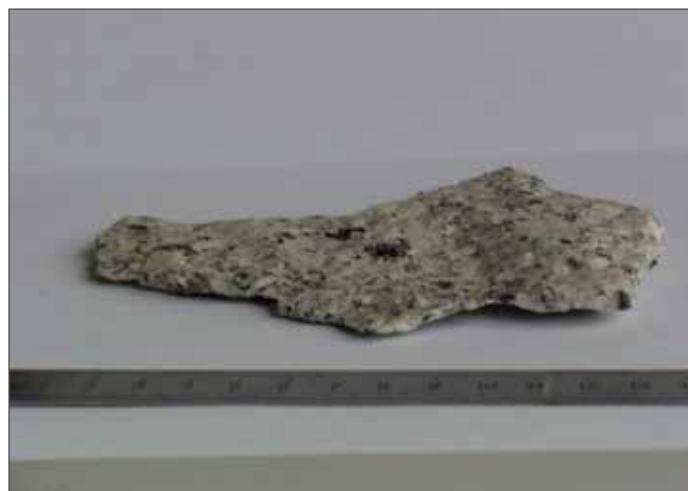
Рис. 2. Фотография плитки отщеп с контура разведочной штольни
