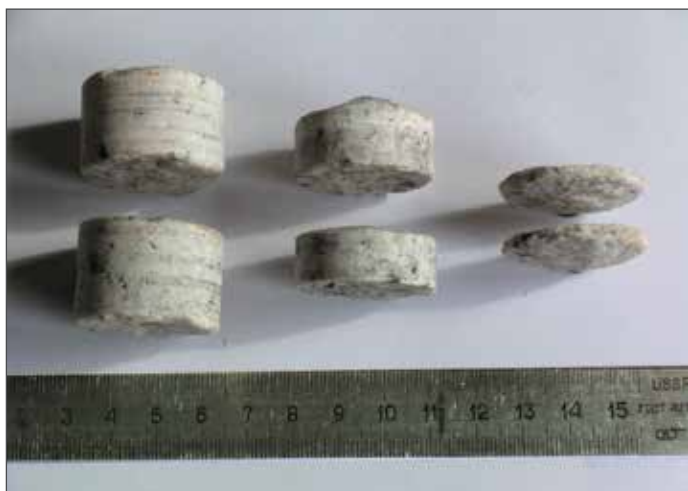
Рис. 1. Фотографии дискования керна
