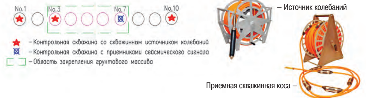
Рис. 3. Описание скважинных исследований: а — схема производства измерений; б — скважинное оборудование
