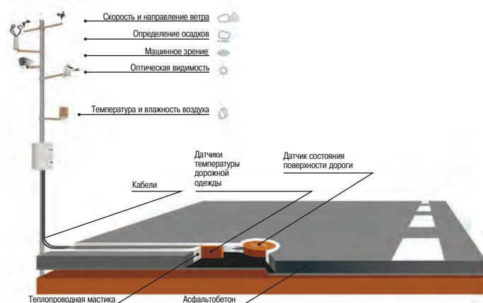
Рис. 1. Автоматическая дорожная метеорологическая станция
