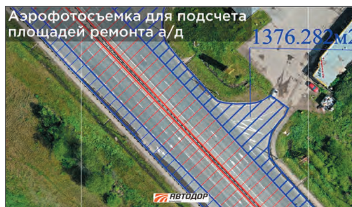
Рис. 6. Подсчет площадей ремонта асфальтового покрытия
