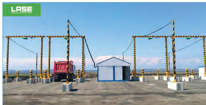
Рис. 1. Лазерные 3D-сканеры в парной комбинации на КПП объекта
