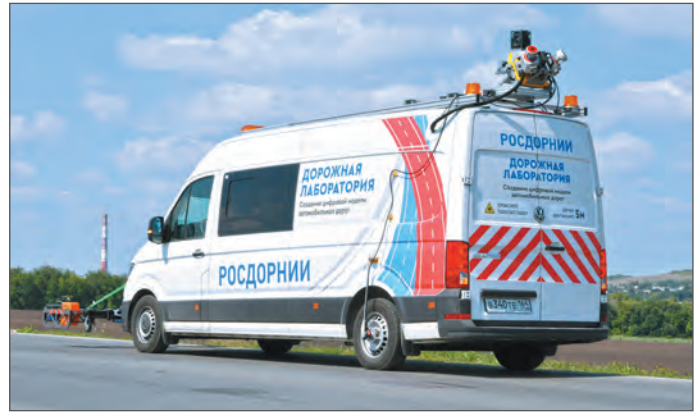
Передвижная дорожная лаборатория RDT-line для создания цифровых пространственных моделей автомобильных дорог
