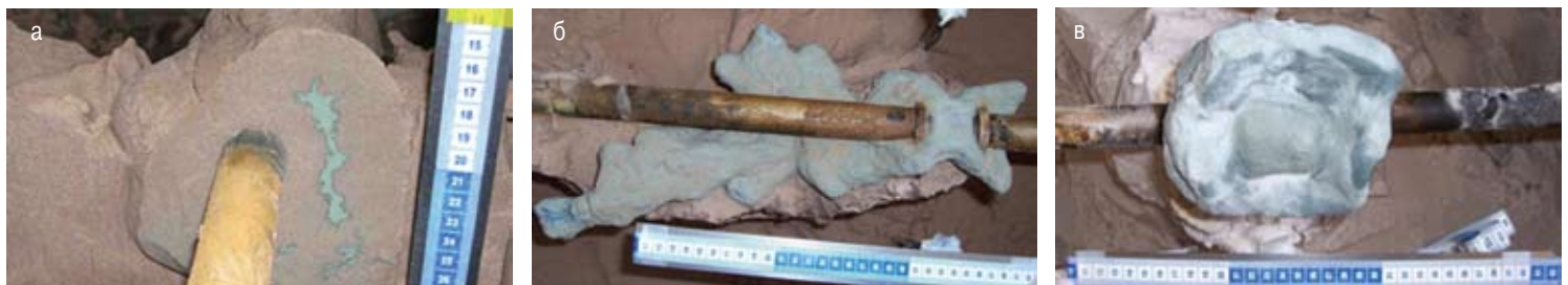
Рис. 3. Результаты лабораторных экспериментов: а – раствор В/Ц=20, нагнетание при расходе q=10 л/м; б – В/Ц=5, q=10 л/м; в – раствор В/Ц=1, нагнетание при расходе q=2 л/м
