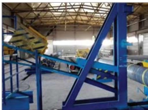
Испытание покрытия «ЗУБ-Композит» на удар 600 кг
