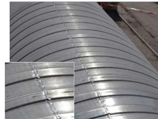
Испытание покрытия «ЗУБ-Композит» на продир элементом 700 кг
