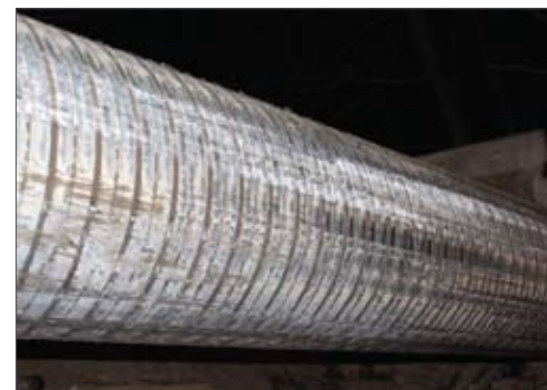
Вид покрытия «ЗУБ-Композит» после протаскивания в скважине
