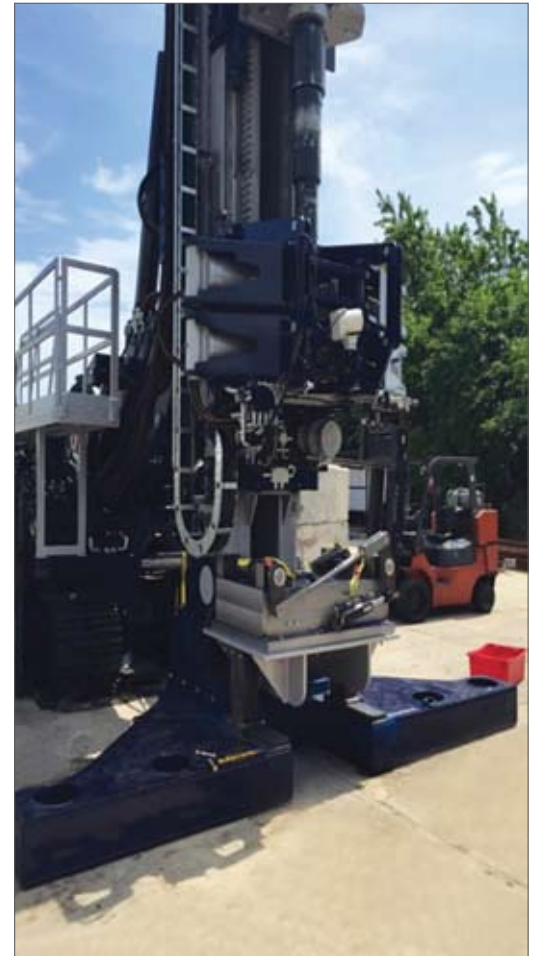
Рис. 9. Клиновой захват на мачте бурового станка, работающий вертикально и в наклонном положении
