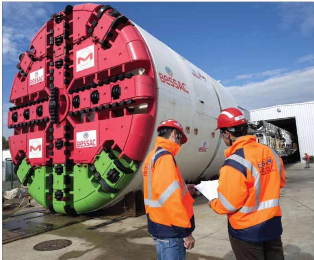
Щит для строительства метрополитена в Минске
