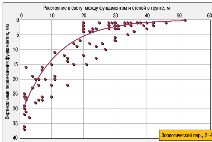
Рис. 10. Величины вертикальных перемещений различных точек фундаментов соседних зданий, в зависимости от расстояния между фундаментами и ограждением
