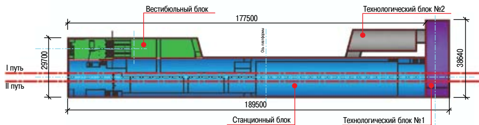
Рис. 1. Пример станционного комплекса, скомпонованного из модулей
