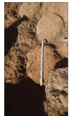
Рис. 4. Опытные грунтоцементные сваи
