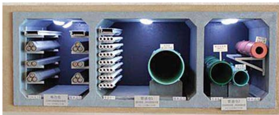
Рис. 7. Схематичный разрез подземного инженерного тоннеля
