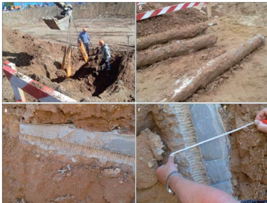
Рис. 3. Использование опытных анкерных свай: а — извлечение из грунта; б — формы раскопанных стволов; в — фрагмент тела анкерной сваи, оставшийся в грунте и спрессованной на контакте со стволом; г — измерение диаметра ствола в грунте
