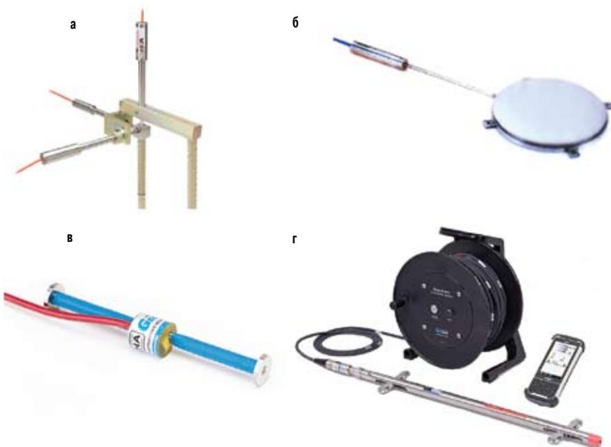
Рис. 2. Типы датчиков, примененных в АСУ ТП строительства Алабяно-Балтийского тоннеля: а – струнный трехосевой трещинономер; б – датчик давления; в – струнный тензодатчик; г – скважинный инклинометр
