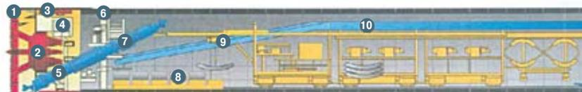
Схема ТПМК с грунтопригрузом забоя: 1 — ротор мехщита; 2 — привод; 3 — герметическая перегородка; 4 — кессонная камера; 5 — шнековый транспортер; 6 — укладчик обделки; 7 — шнековая задвижка; 8 — тьюбинговый транспортер; 9 — кран для тьюбингов; 10 — лента транспортера; 11 — щитовые домкраты
