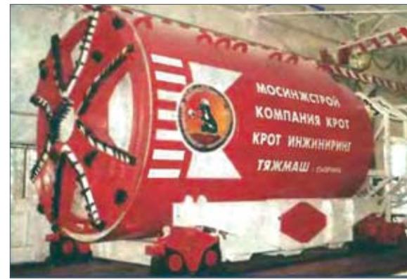
Топаз-4 — проходческий щитовый комплекс для сооружения тоннелей в сложных горно-геологических (в том числе гидрогеологических) условиях
