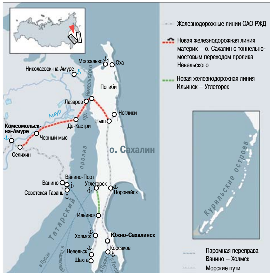
Рис. 1. Железнодорожная линия материк – о. Сахалин (Селихин – Ныш) с транспортным переходом через пролив Невельского
