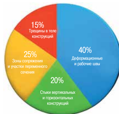
Рис. 1. Классификация источников водопроявлений в подземных сооружениях
