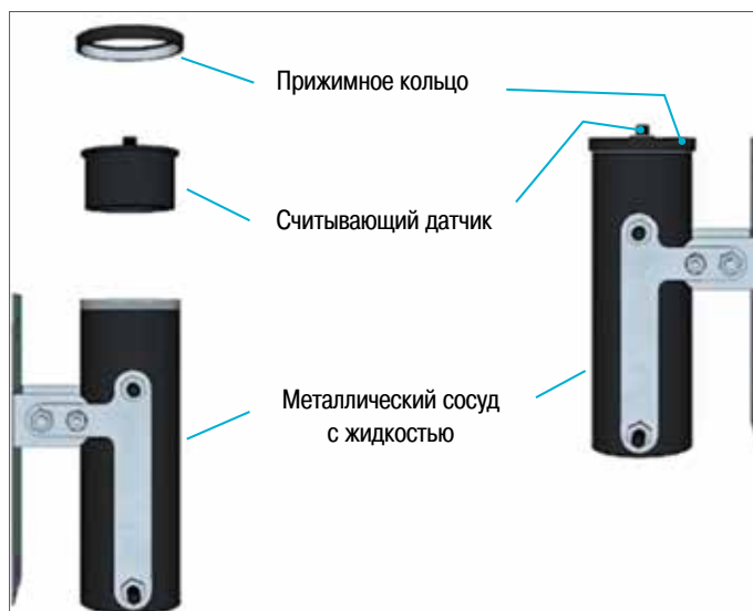
Рис. 1. Конструкция датчика гидростатического нивелирования
