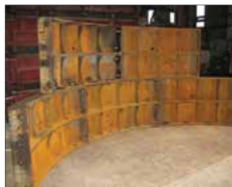
Рис. 7. Сборка чугунных тубингов, моделирующих участок ствола
