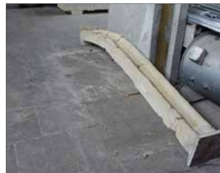
Рис. 2. Опытный образец после огневого воздействия
