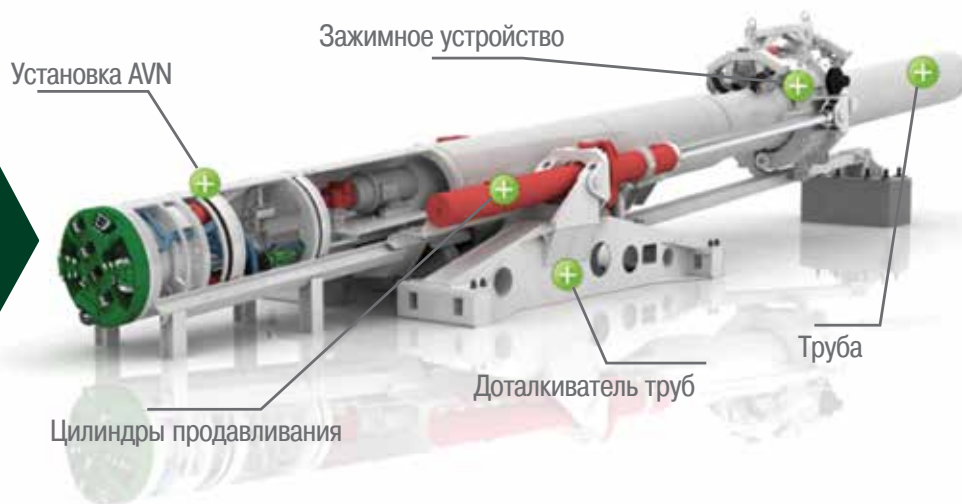
Рис. 1. Основные компоненты Direct Pipe®
