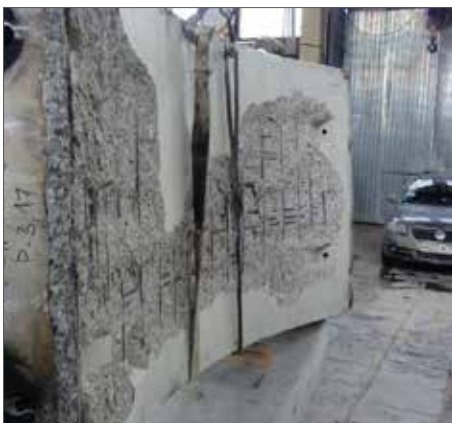
Рис. 6. Железобетонный тубинг с добавкой полипропиленовой микрофибры после огневых испытаний
