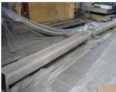
Рис. 1. Опытные образцы стальных колонн перед испытанием под нагрузкой
